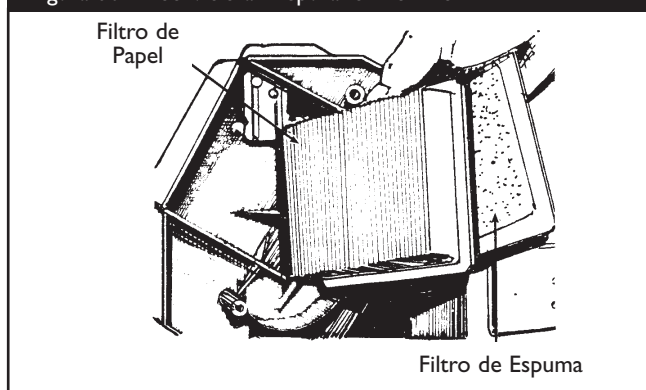
Figura 36 — Servicio al Depurador de Aire
